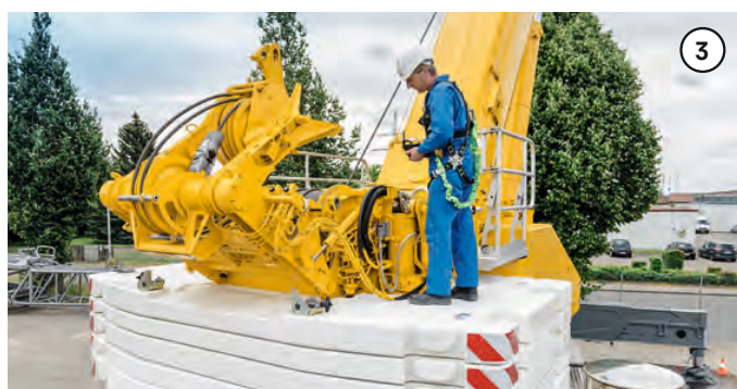
1 Winch 2 secured to the ballast plate Treuil 2 fixé sur la plaque de lest
